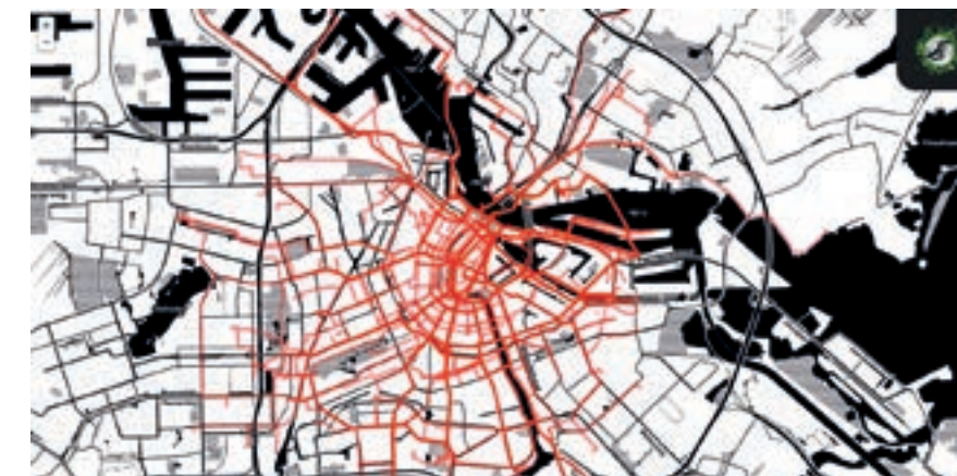
Kaart van de bezoekersstromen tijdens SAIL 2015. Hoe dikker en roder de lijn, hoe meer mensen er in die straat liepen. Het geeft een beeld van knelpunten: als een lichtrode straat overgaat in een donkerrode, is er mogelijk iets mis op het kruispunt dat ertussen zit.
